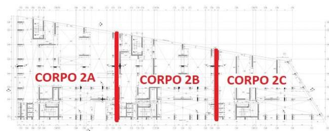
Figure 8. Building ENI2: structural joint in basement levels /Edificio ENI2 posizioni giunti nei piani interrati.
