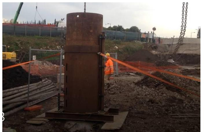
Fig. 29. Vertical load test on pile foundation/prova di carico verticale su palo di fondazione.
