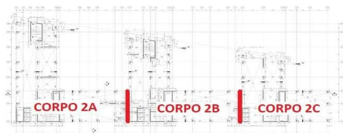
Figure 9. Building ENI2: structural joint in external levels /Edificio ENI2 posizioni giunti nei piani fuori terra.
