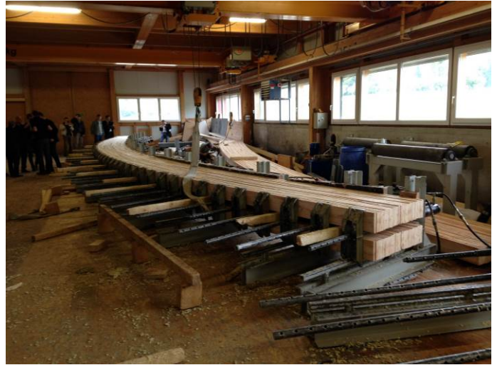
Figure 22: Glued phase of timber laminated column / dettaglio di incollaggio di una colonna in legno lamellare
