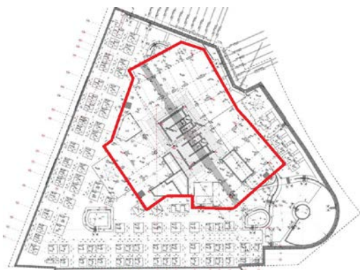
Figura 2 – Platea di fondazione della Torre Park Tower
