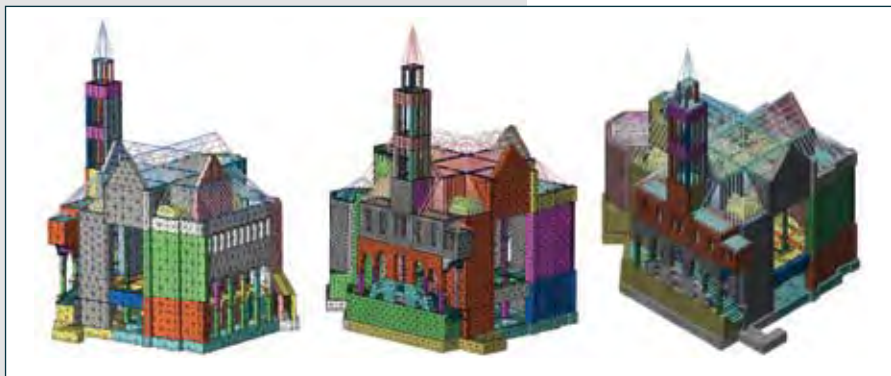
Figura 2: I tre modelli numerici del Santuario (100, 50 e 25 cm)
